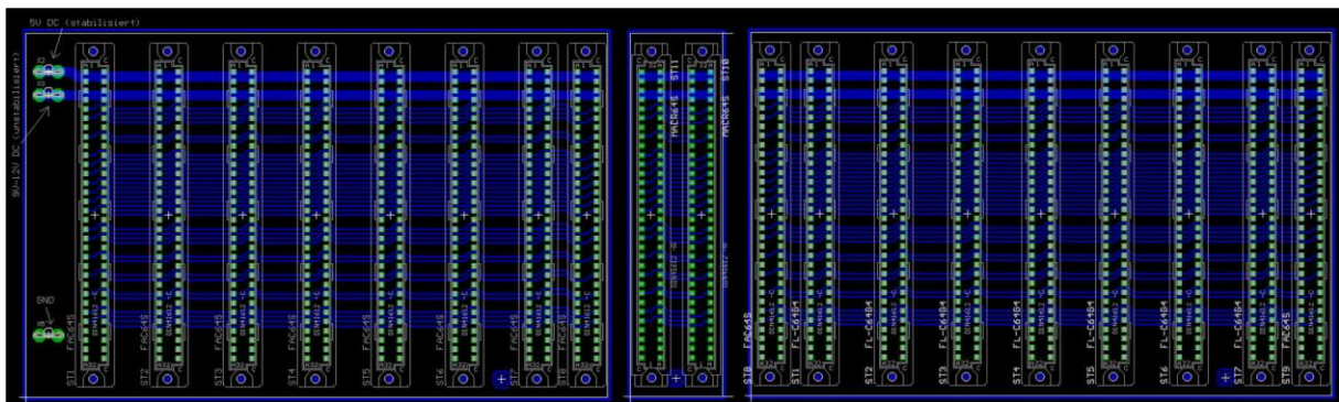
MoBaSbS-Backplane erweitert, Platinen-Layout
